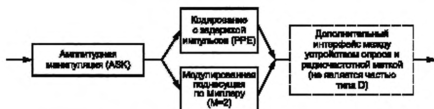
Рисунок 4 — Структура устройства опроса типа D
