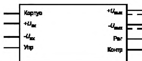
Рисунок Б.1 — Расположение выводов одноканальных СЭМ
