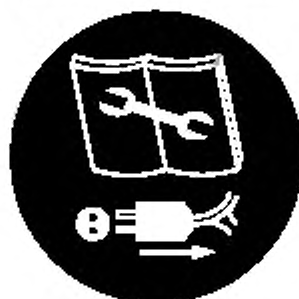
Рисунок АА.2 — Знак безопасности, обозначающий: «ВНИМАНИЕ. Отсоедините вилку от сети перед техническим обслуживанием или в случае повреждения шнура питания»
