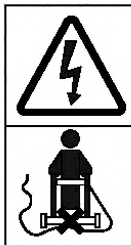
Рисунок АА.3 — Знак безопасности, обозначающий: «ВНИМАНИЕ. Держите шнур питания на удаленном расстоянии от ножа»
