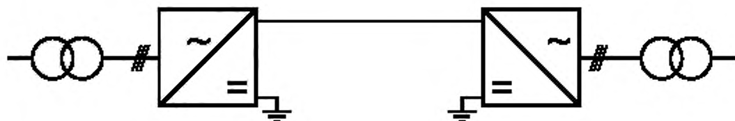
Рисунок 10 — Асимметричная монополярная система ПТВН на основе преобразователей напряжения с возвратом тока по земле
