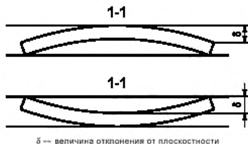
Рисунок 4 — Схема проверки АКЛ на отклонение от плоскостности
