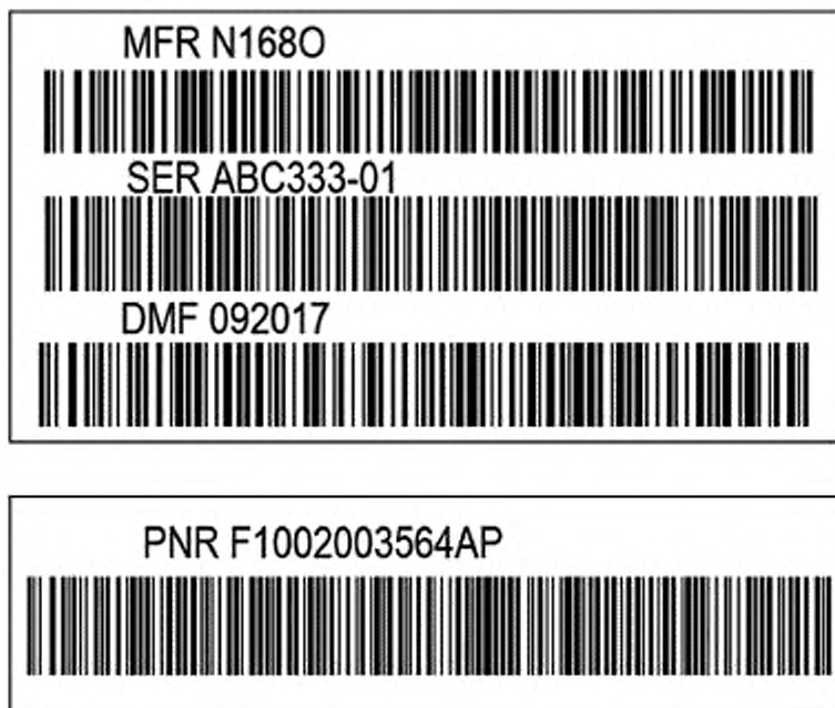
Рисунок 5 — Сокращенный состав данных, линейные символы штрихового кода, поле «PNR» на отдельной табличке
