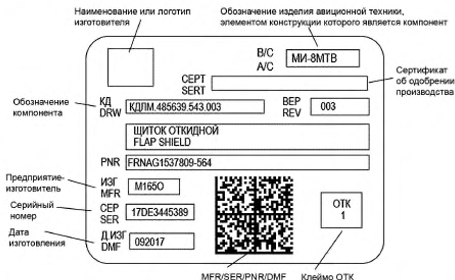
Рисунок 1 — Опознавательная табличка с полным составом данных по [1] для компонента АТ II класса, поле «PNR» на основной табличке в одном символе штрихового кода с данными MFR, SER, DMF
