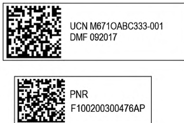
Рисунок 7 — Сокращенный состав данных, матричные символы штрихового кода, поле «MFR» и поле «SER» заменены на поле «USN» (универсальный серийный номер)
