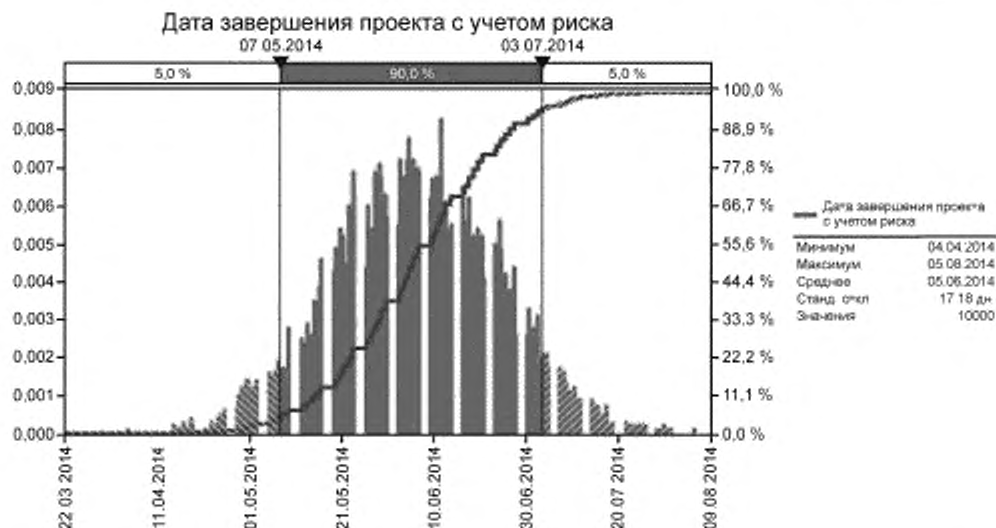
Рисунок 4 — Пример результата моделирования рисков по срокам проекта (диаграммы плотности распределения и S-кривая)
