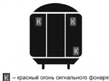
Рисунок 1 — Размещение сигнальных фонарей на торцевых стенах вагона
