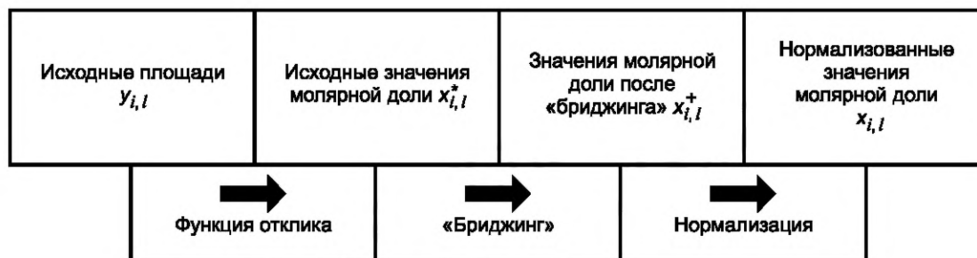
Рисунок В.2 — Блок-схема процесса преобразования данных
