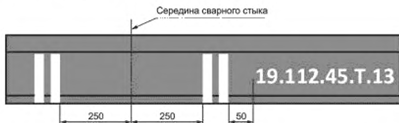
Рисунок 3 — Маркировка стыка РКС, сваренного в пути (размеры в миллиметрах)
