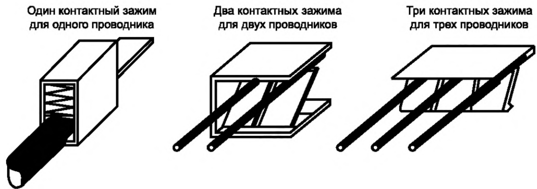
Рисунок F.6 — Примеры безвинтовых контактных зажимов
