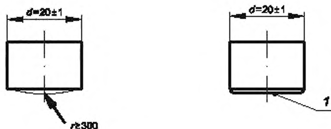
Сферическая поверхность бойка (А) Плоская поверхность бойка (В) d — диаметр бойка; r — радиус скругления ударной поверхности бойка; 1 — плоская поверхность бойка со скругленными краями
