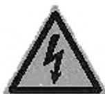
а) «Опасность поражения электрическим током» (ГОСТ 12.4.026—2015. W08)
