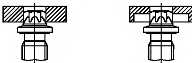
c — Проверка калибром В
