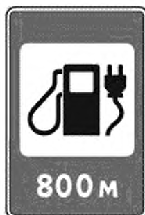
7.21 Автозаправочная станция с возможностью зарядки электромобилей
