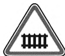
1.1 Железнодорожный переезд со шлагбаумом
