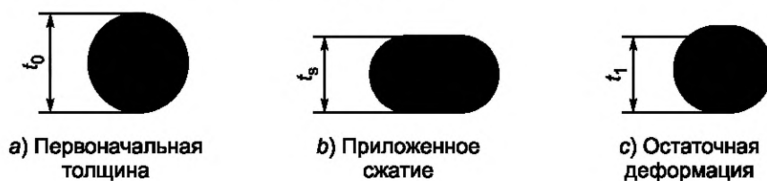
Рисунок 10 — Остаточная деформация при сжатии уплотнительного кольца
