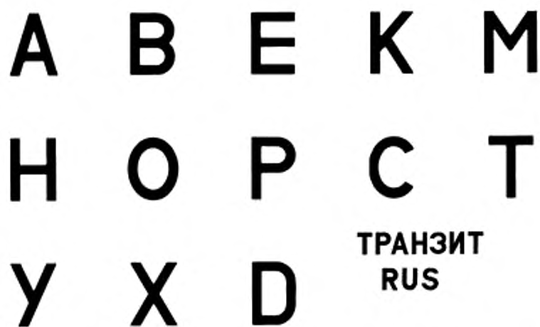
Рисунок Б.1 — Шрифт букв, разрешенных для использования на регистрационных знаках
