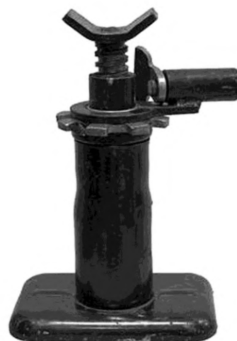
Рисунок 4 — Пример стоечного домкрата
