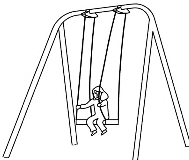
Рисунок 2 — Пример качелей с несколькими осями вращения (тип 2)
