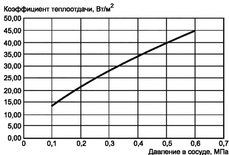
Рисунок Д.1 — Значения коэффициента теплоотдачи при естественной конвекции для метана Общий расход греющего газа на отопление сосуда M_G , кг, вычисляют по формуле
