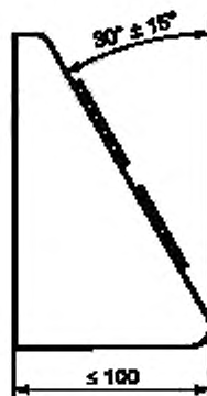
Рисунок В.1 — Панель управления кабиной. Пример вида сбоку
