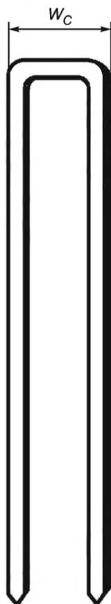
Рисунок А.18 — Схематическое изображение измерения размера свода скобы
