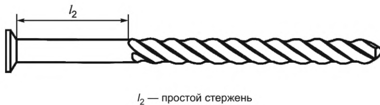
Рисунок А.20 — Схематическое изображение простого стержня гвоздя с резьбой
