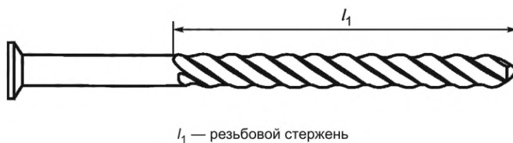
Рисунок А.21 — Схематическое изображение резьбового стержня выпуклого винтового гвоздя
