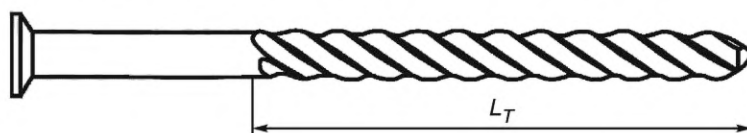
Рисунок А.3 — Схематическое представление измерения длины резьбы
