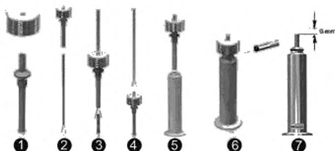
Рисунок 5 — Пошаговая установка фитиля
