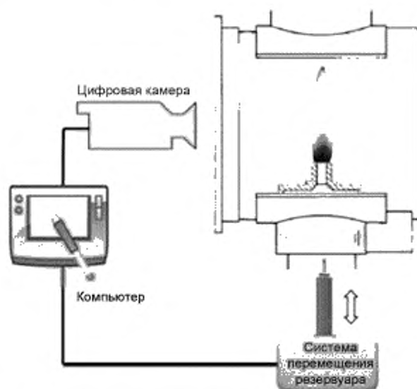
Рисунок 2 — Принцип работы аппарата (автоматического) для определения максимальной высоты некопящего пламени
