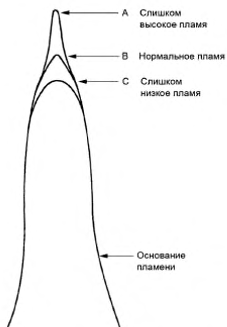
Рисунок 6 — Типовые формы пламени
