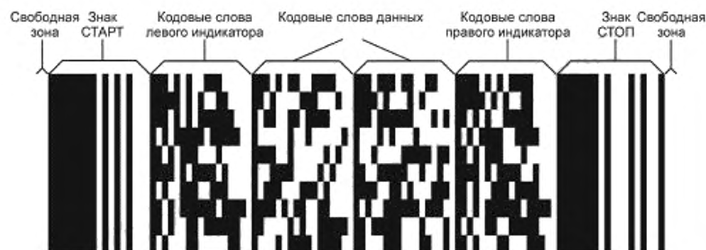
Рисунок 1 — Структура символа PDF417
