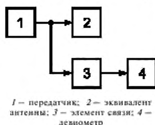
Рисунок 26 — Схема измерения девиации несущей частоты, вызываемой немодулированной поднесущей и пилот-тоном
