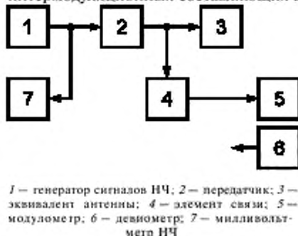
Рисунок 23 — Схема измерения ПАМ и СПАМ передатчика
