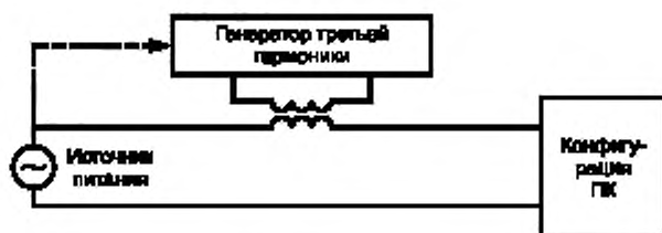
Рисунок 10 — Испытание на устойчивость к напряжению третьей гармоники
