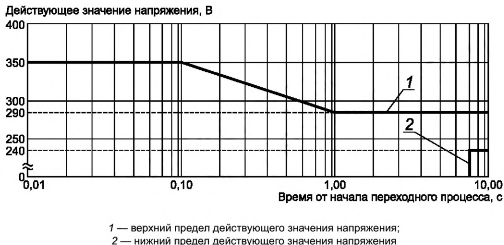
Рисунок 15 — Пределы приведенных значений ненормальных повышенных и пониженных напряжений систем постоянного тока 270 В
