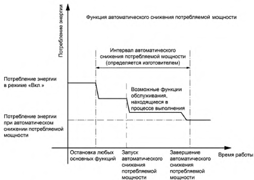
Рисунок 6 — Функция автоматического снижения потребляемой мощности
