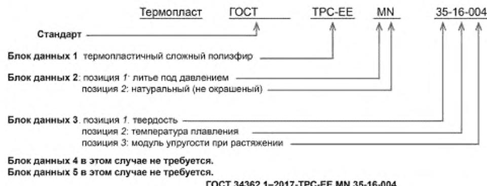
Термопластичный сополимер на основе сложного полизфира/сложного эфира, полученный из бутандиол/терефталевой кислоты и капролактона (TPC-ES), предназначенный для литья под давлением (M), натуральный (не окрашенный) (N), термостабилизированный (H), с твердостью 48 (50), температурой плавления 200 °С (20) и модулем упругости при растяжении 127 МПа (015) следует обозначить:
