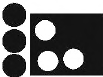
Рисунок 3 — Нарезка дисков из листа материала при помощи кольцевого вырубного штампа
