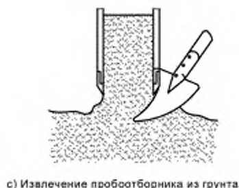
Рисунок С.30 — Примеры взятия пробы из разведочных шурфов
