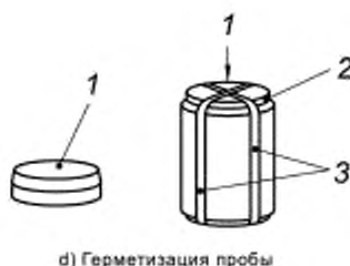
Рисунок С.30 — Примеры взятия пробы из разведочных шурфов
