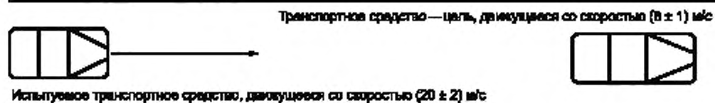
Рисунок 10 — Расположение транспортных средств при испытаниях функциональных возможностей
