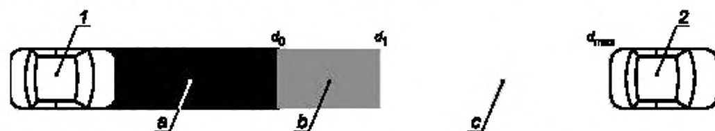
1 — испытуемое транспортное средство; 2 — транспортное средство, движущееся впереди; a — обнаружение не требуется; b — требуется обнаружение транспортного средства, c — требуется определение расстояния
