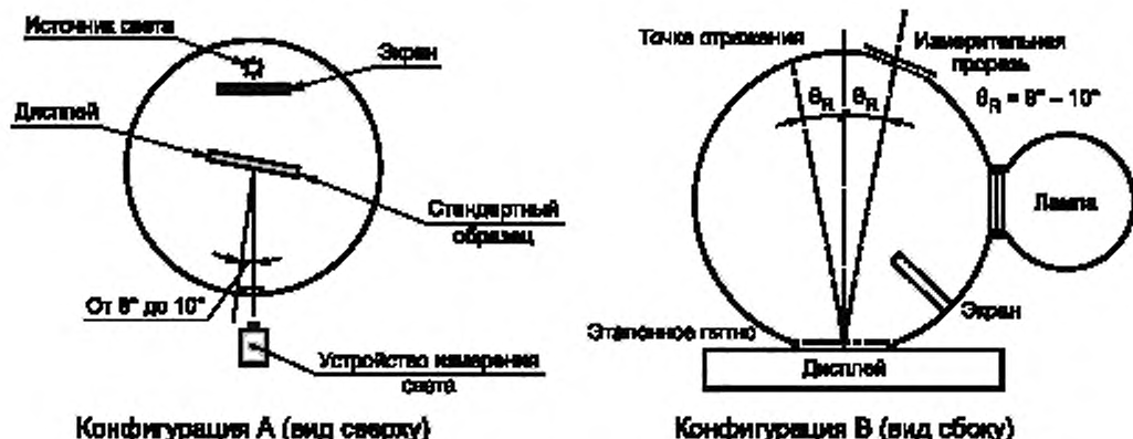
Рисунок 6 — Пример геометрической конфигурации измерения при полусферическом освещении с использованием фотометрического шара (слева) и эталонной сферы (справа)
