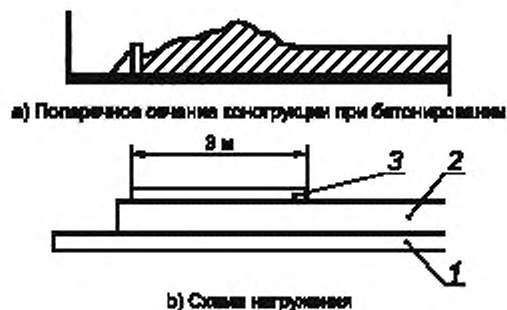
1 — участки доступа: минимальная рабочая нагрузка класса 1 в соответствии с EN 12811-1; 2 — нагрузка от веса поддерживаемого бетона; 3 — поправка на скопление бетона при бетонировании
