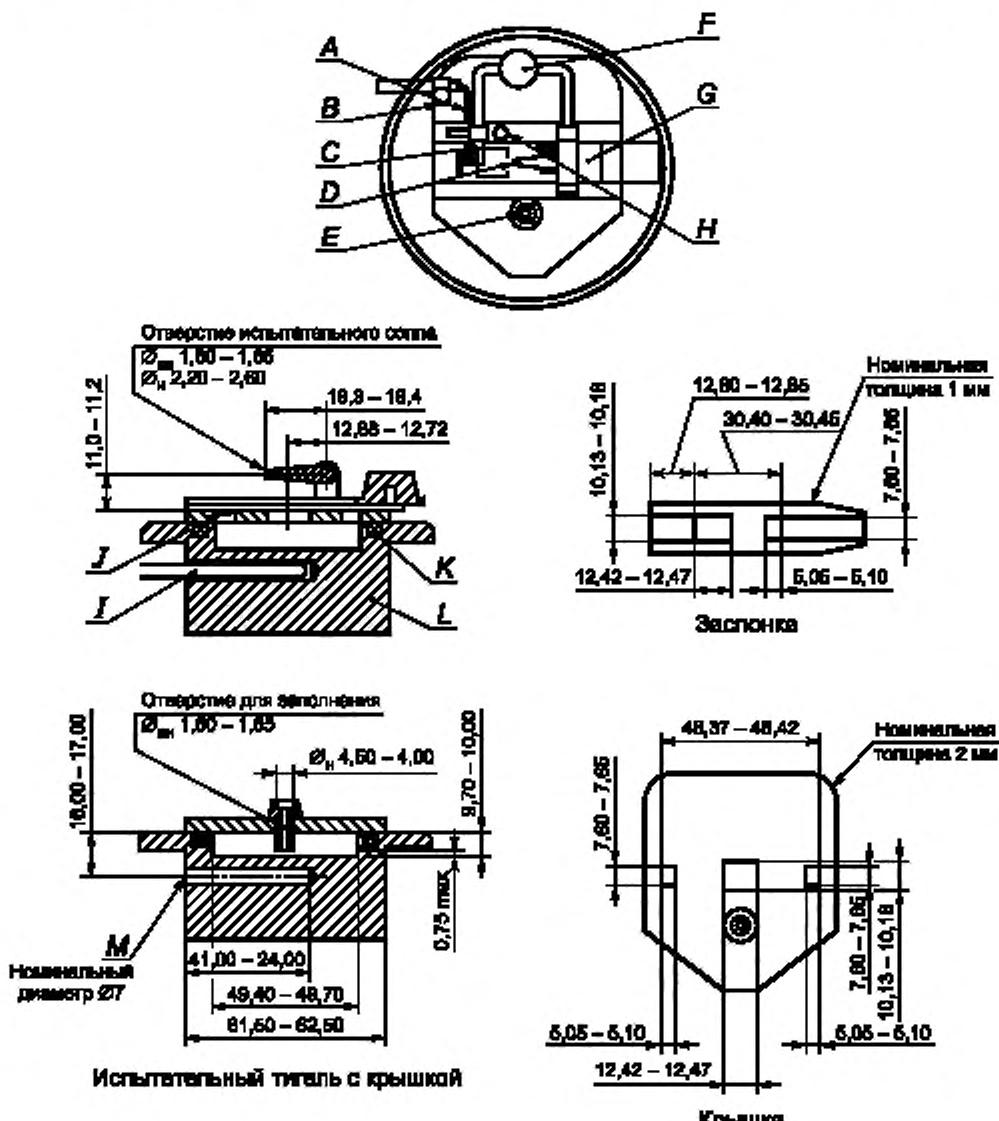
A — детектор вспышки; B — крышка; C — сопло запального пламени; D — сопло испытательного пламени; E — отверстие для заполнения; F — винт регулировки испытательного газового пламени; G — заслонка; H — шаблон испытательного пламени; I — термометр; J — центровочный паз детектора вспышки; K — кольцевое уплотнение крышки; L — блок испытательного тигля; M — карман для термометра
