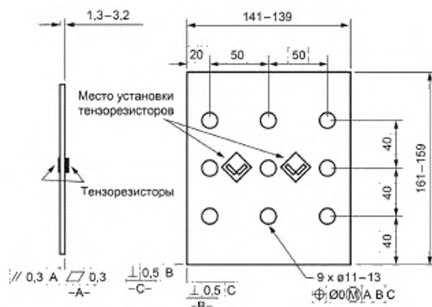
Рисунок 8 — Метод В. Образец, размеры в мм
