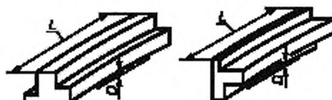
L — длина профиля; D — допустимое отклонение от прямолинейности (допуск)
