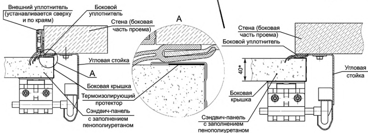
Рисунок Д.3 — Сечение секционных ворот (3D)
