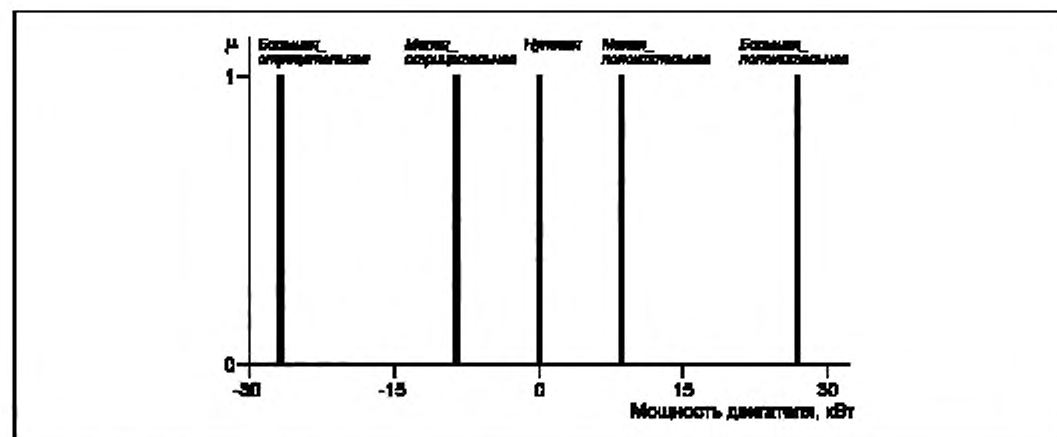
Рисунок С.4 — Лингвистическая переменная «мощность»
