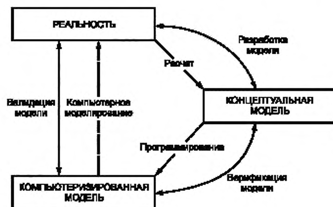
Рисунок 1 — Пример этапов разработки и оценки компьютерных (компьютеризированных) моделей
