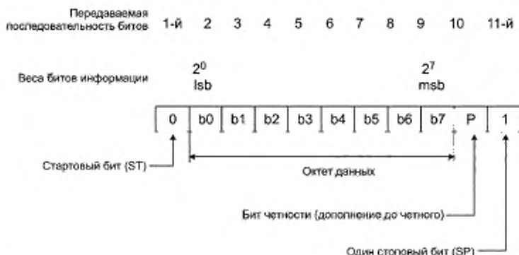
Рисунок 18 — Формат фрейма UART в технологии SDCI
