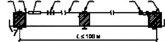
1 — колонна, 2 — двухплетевой стальной канат, 3 — талреп, 4 — зажимы для образования петли; 5 — стальной канат диаметром не менее 6 мм, 6 — промежуточный фиксатор положения каната; 7 — край перекрытия
