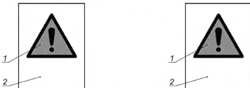
1 — знак W001 «Общее предупреждение» — согласно ISO 7010; 2 — дополнительный текст «Опасность опрокидывания!»
