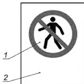
1 — знак P004 «Нет прохода» — согласно ISO 7010; 2 — дополнительный текст «Нет доступа»
