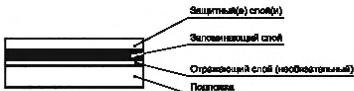
Рисунок 1 — Поперечное сечение элемента аутентификации для карт с оптической памятью
