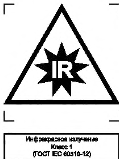
Рисунок GG.1 — Пример предупредительной маркировки для инфракрасного излучения
