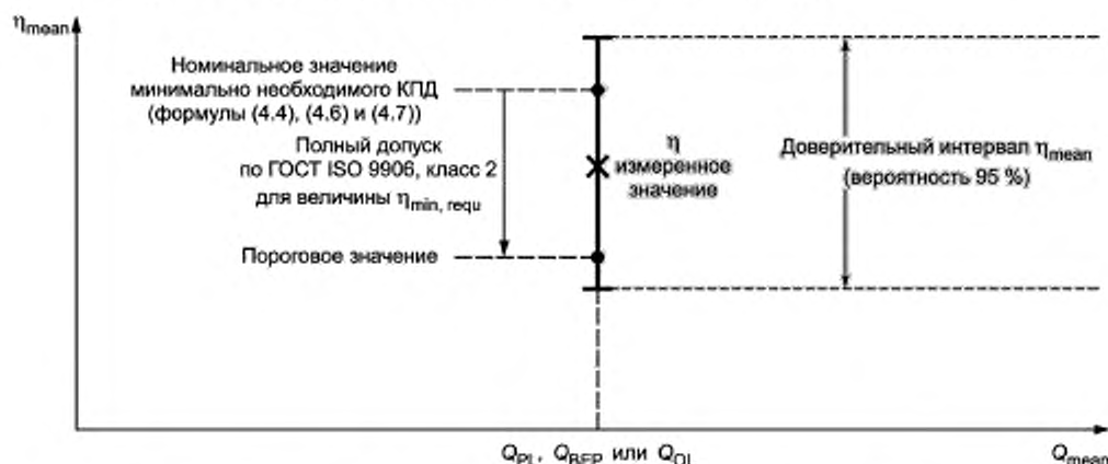
Рисунок С.2 — Влияние общих допустимых отклонений измеренных величин КПД (вариант 1)
