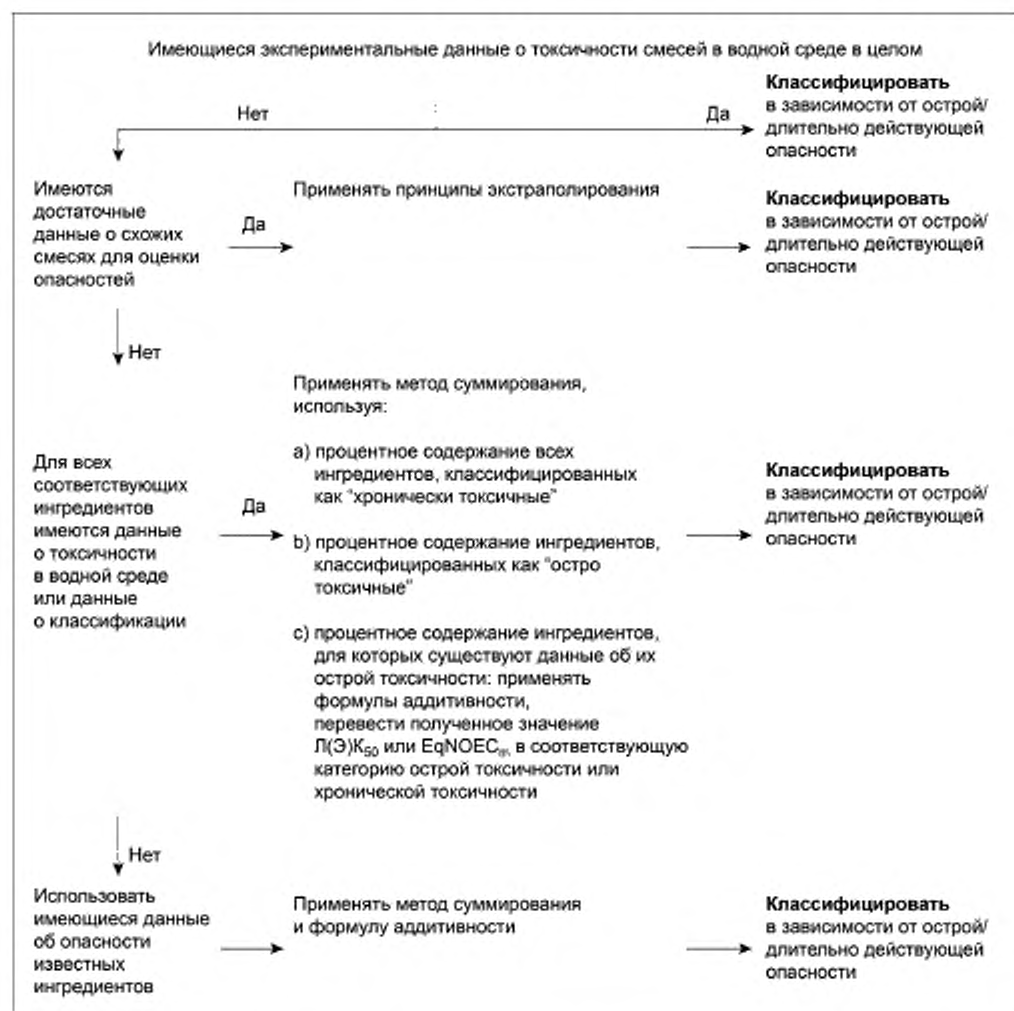
Рисунок Б.5 — Ярусный подход к классификации смесей в зависимости от их острой и длительно действующей опасности для водной среды
