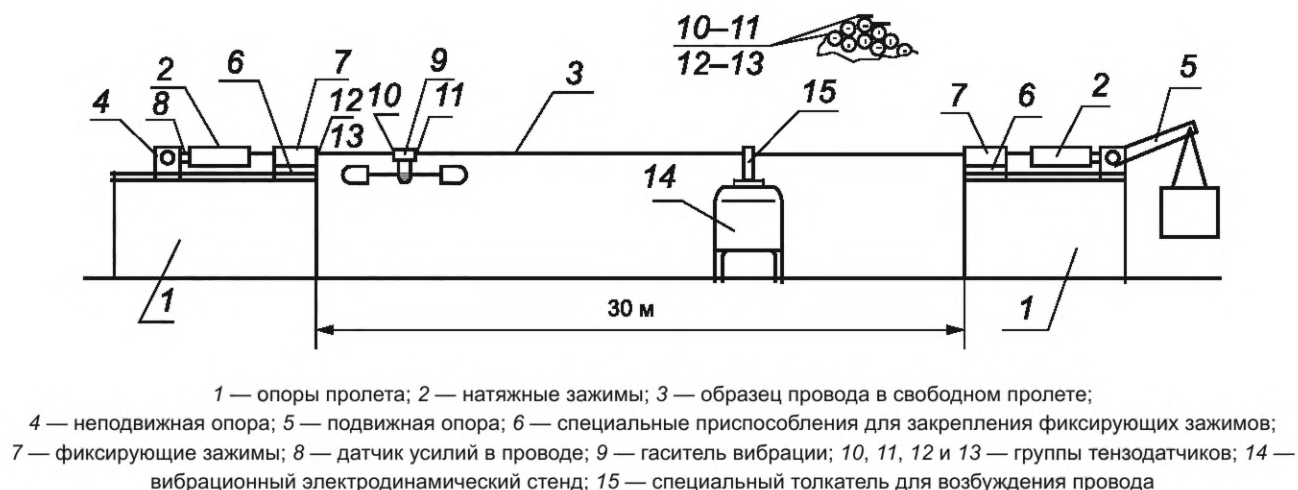
Рисунок 16 — Схема опытного пролета установки для определения коэффициента эффективности работы гасителя вибрации на проводе
