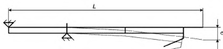
Рисунок 2 — Схема измерения прогиба штанги
